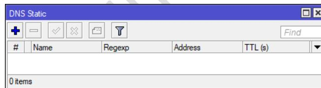
Untuk menambahkan **static DNS**, pilih tombol pada toolbar dari kotak dialog **DNS Static** maka akan tampil kotak dialog **New DNS Static Entry** seperti terlihat pada gambar berikut:
