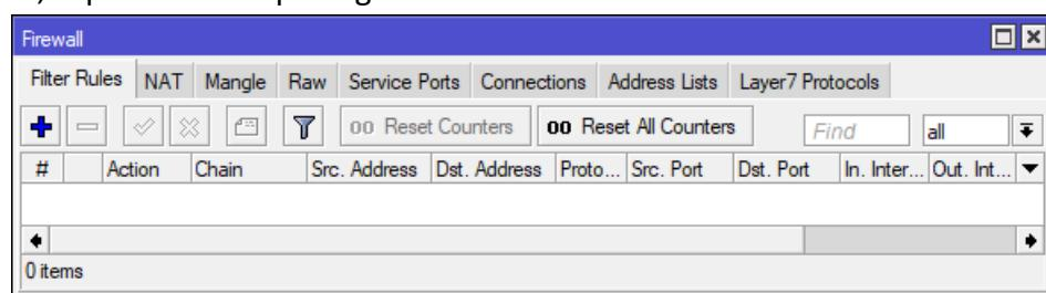
Untuk menambahkan **Filter Rules** agar menolak ping ke router Mikrotik dari client dengan rentang alamat IP tertentu, pilih tombol
