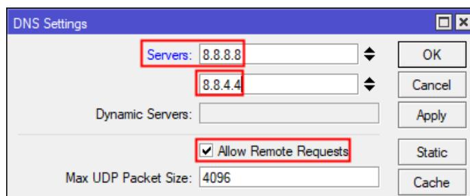
7. Mengatur **static DNS** agar ketika mengakses **www.mikrotik.com** maka akan dialihkan ke **bsnp-indonesia.org**. Pada kotak dialog **DNS Settings**, klik tombol **Static** maka akan tampil kotak dialog , seperti terlihat pada gambar berikut:
