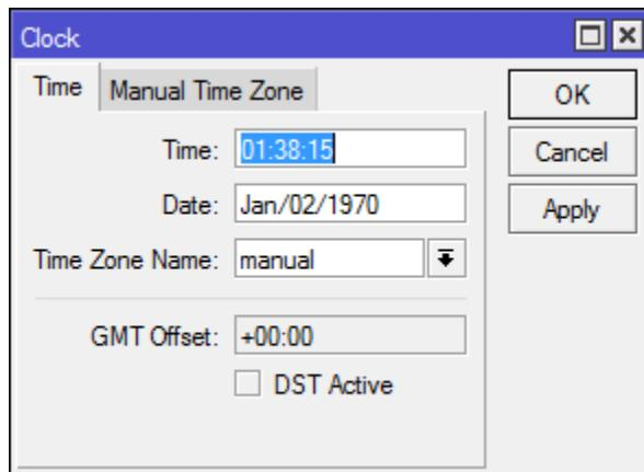
Pada kotak dialog **Clock** tab **Time**, lakukan pengaturan parameter **Time Zone Name** dengan memilih pilihan “**Asia/Makassar**”, seperti terlihat pada gambar berikut:
