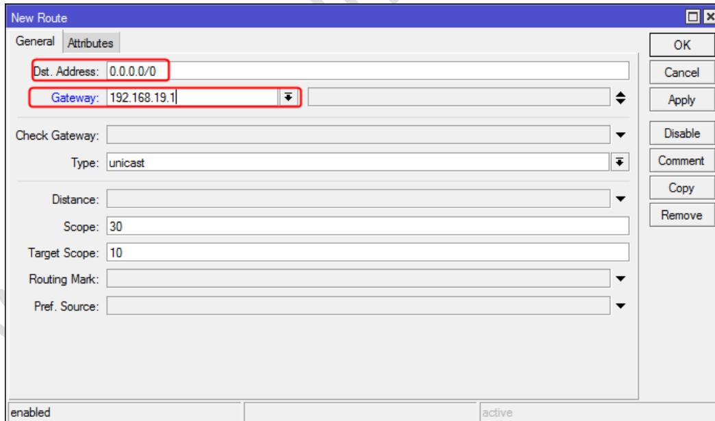
Pada parameter **Gateway** masukkan alamat IP **192.168.19.1** (**SESUAIKAN DENGAN ALAMAT IP GATEWAY YANG DIBERIKAN ISP**). Untuk menyimpan perubahan ketika tombol **OK**. Hasil dari penambahan *default route* ini, terlihat seperti pada gambar berikut:
