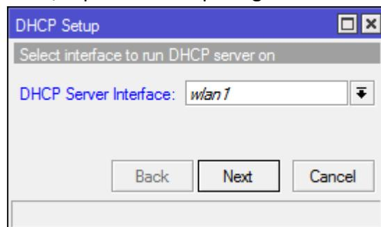
Pilih **wlan1** untuk pembuatan DHCP Server bagi WLAN, dan klik tombol **Next**. Tampil kotak dialog **DHCP Setup** untuk menentukan alamat jaringan yang dialokasikan untuk alamat DHCP, seperti terlihat pada gambar berikut:
