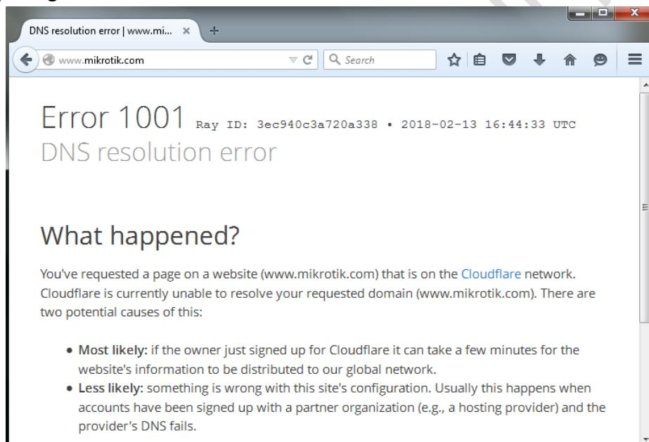
Terlihat muncul **pesan kesalahan resolusi DNS** yang menginformasikan bahwa **Cloudflare** tidak dapat memetakan domain yang diminta. Pengaturan **DNS static** sudah benar namun khusus untuk [www.mikrotik.com](http://www.mikrotik.com) yang dialihkan ke [bsnp-indonesia.com](http://bsnp-indonesia.com) tidak dapat digunakan.
