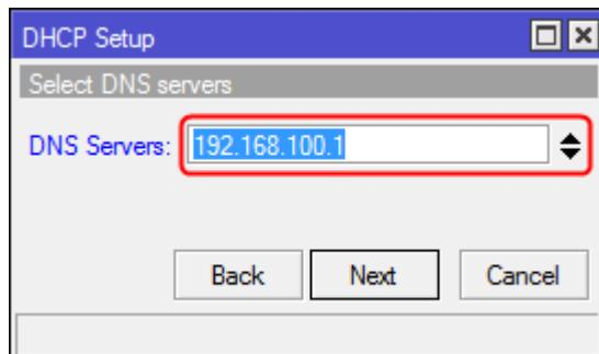
Masukkan alamat IP dari router Mikrotik **192.168.100.1** sebagai DNS Server, kemudian klik tombol **Next**. Tampil kotak dialog **DHCP Setup** untuk menentukan waktu sewa alamat IP ke client DHCP, seperti terlihat pada gambar berikut:
