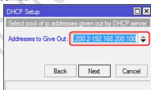
Masukkan alamat IP **192.168.200.2-192.168.200.100**, dan klik tombol **Next**. Tampil kotak dialog **DHCP Setup** untuk menentukan alamat DNS Servers, seperti terlihat pada gambar berikut:
