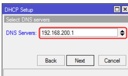
Masukkan alamat IP dari router Mikrotik yaitu **192.168.200.1**, kemudian klik tombol **Next**. Tampil kotak dialog **DHCP Setup** untuk menentukan waktu sewa alamat IP ke client DHCP, seperti terlihat pada gambar berikut:
