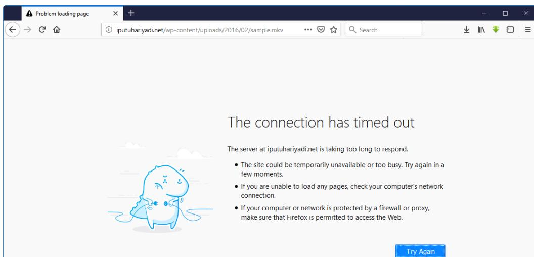
6. Mengakses situs yang mengandung konten “**mikrotik**” dari salah satu situs di Internet yang telah diatur untuk **diblokir khusus bagi client WLAN** sebagai contoh <https://wiki.mikrotik.com>. Hasil ujicoba, seperti terlihat pada gambar berikut:
