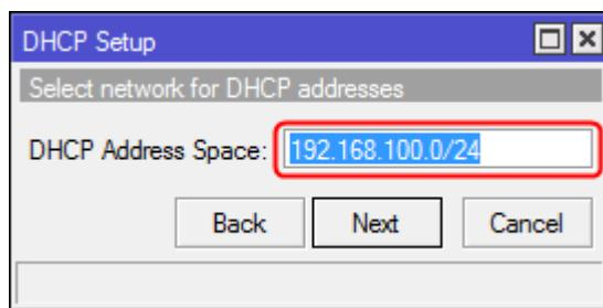
Masukkan alamat jaringan **192.168.100.0/24**, dan klik tombol **Next**. Tampil kotak dialog **DHCP Setup** untuk menentukan alamat gateway untuk jaringan DHCP, seperti terlihat pada gambar berikut:
