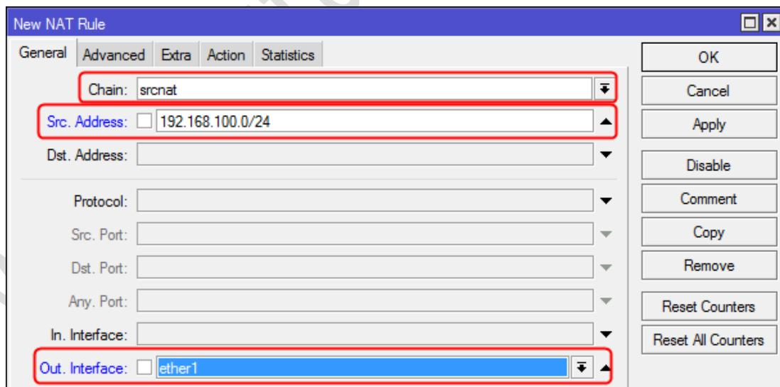
Selanjutnya pindah ke tab **Action**, dan atur parameter **Action** dengan pilihan **masquerade** yang berfungsi untuk melakukan translasi alamat IP sumber menjadi alamat IP yang digunakan oleh *interface ether1* sebagai interface yang terhubung ke Internet, seperti terlihat pada gambar berikut.
