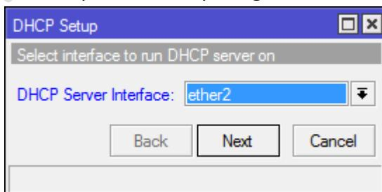
Pilih **ether2** untuk pembuatan DHCP Server bagi LAN, dan klik tombol **Next**. Tampil kotak dialog **DHCP Setup** untuk menentukan alamat jaringan yang dialokasikan untuk alamat DHCP, seperti terlihat pada gambar berikut:
